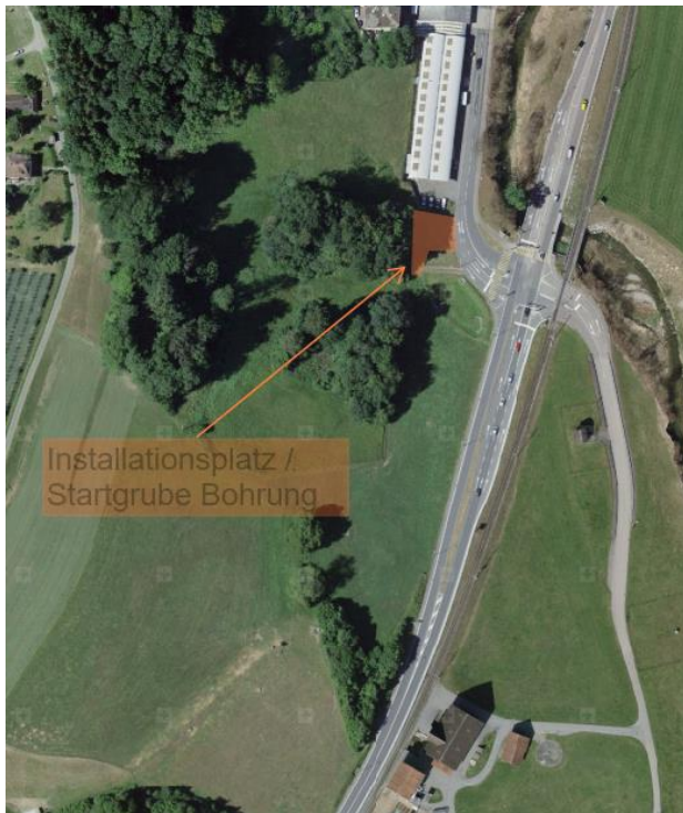
Abbildung 12: Startgrube Spülbohrung und Installationsplatz für Leitung im offenen Graben in der Industriestrasse. Quelle: maps.geo.admin.ch.
