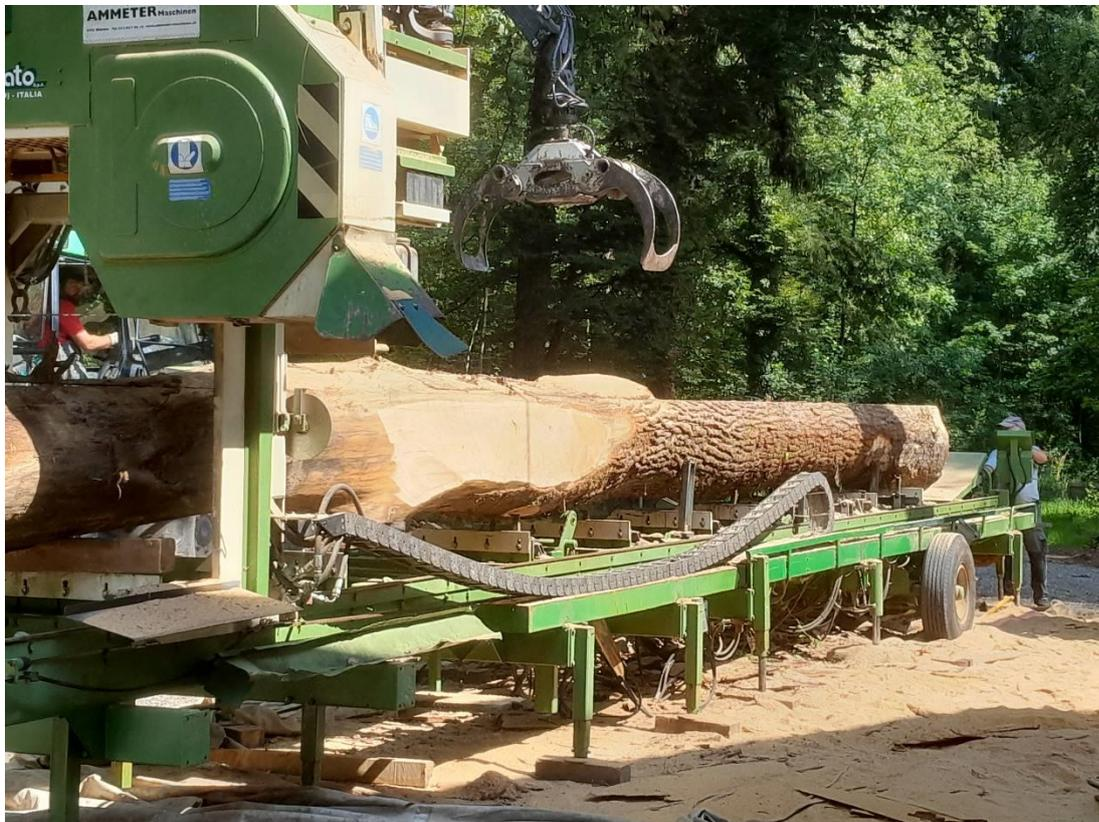
Immer wichtiger werden für uns Produkte, die wir weiterverarbeiten, hier eine mobile Säge im Einsatz beim Schneiden von eichigen Trägerbalken für eine Fussgängerbrücke.
